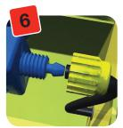
Il est maintenant possible de raccorder l'AQUAvalve au tuyau de 6mm. Dévissez le collier jaune et faites passer le tube dedans. Poussez le tuyau de 6mm sur l'embout de l'AQUAvalve, puis remettez le collier jaune en place en le vissant sur l'AQUAvalve.
